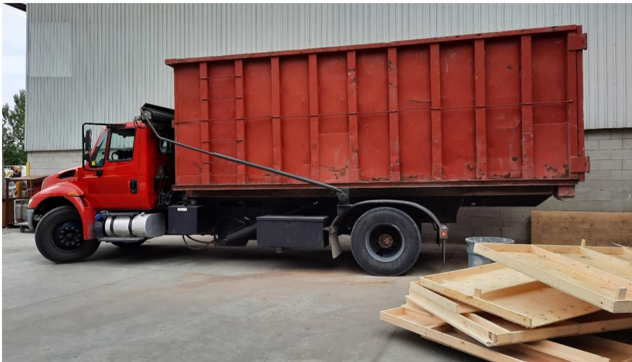
Camion porteur à faux-cadre basculant assurant l'enlèvement de matériaux de construction. Crédit photo : Samantha Leigh, Green Spark Group
